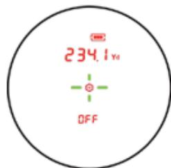
競技会への参加などで高低差計測を OFF にして使用する場合は、電源が入った状態で本体のモード切替ボタンを3秒ほど「長押し」すると、目安距離と高低差が表示される部分が OFF の表示になり、目安距離と高低差が表示されなくなります。
