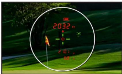
2. 計測中は
