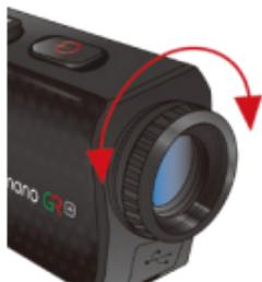
見えにくい場合は、焦点調節リングを回して調整してください。
