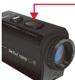
ファインダーを覗いて電源・計測ボタンを「短押し」してください。電源が入るとファインダー内に表示が出ます。約 10 秒間、何も操作を行わないと自動で電源が切れます。
