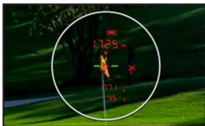
3. 照準がピンフラッグに合うと、振動とともに
