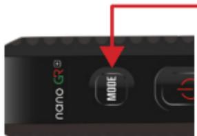
電源が入った状態で、モード切替ボタンを 2 回連続で押すと 3 段階で明るさを調整できます。
